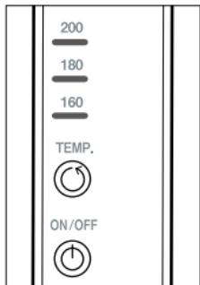
③温度調整スイッチで希望温度に設定する。
