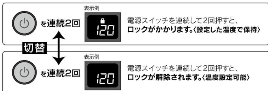
※ロック状態でも電源スイッチを長押しすると、電源がOFFになります。
