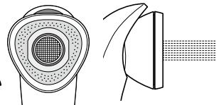
泡沫モードから、ヘッドを時計回りに60°回転させると、直流シャワーモードに切り替わります。
