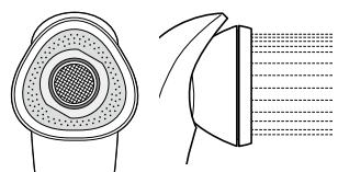
直流シャワーモードから、ヘッドを反時計回りに60°回転させると、泡沫モードに切り替わります。
