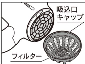
**吸込口** ※吸込口キャップは左に回すと簡単に取り外せます。
