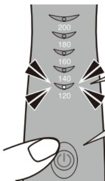
温度表示ランプが点滅から点灯に変われば使用可能。
